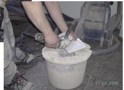
Till höger Johan Källs lösning. En hink kopplad till en dammsugare som skapar undertryck och en plyfa ovanpå.
