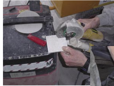
Till höger Johan Källs lösning. En hink kopplad till en dammsugare som skapar undertryck och en plyfa ovanpå.
