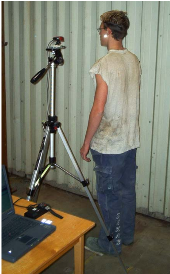
Figur 1. Mätning av balans. Mätutrustningen är fixerad på ett stativ och detektorn är vinkelrätt riktad mot reflexpunkten (under örsnibben). På bordet ses också datorn för datainsamlingen och en avspelningsenhet för pulsmätarna (höger om datorn)
